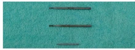
図3: 歯の分割に用いる切削器具 (ラウンドバー、フィッシャーバー、ダイヤモンドポイント(101L))
